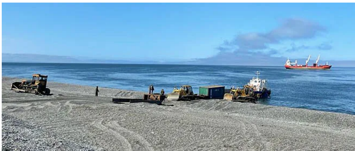
Рисунок 2. – Выгрузка контейнера на необорудованный берег с использованием баржи
